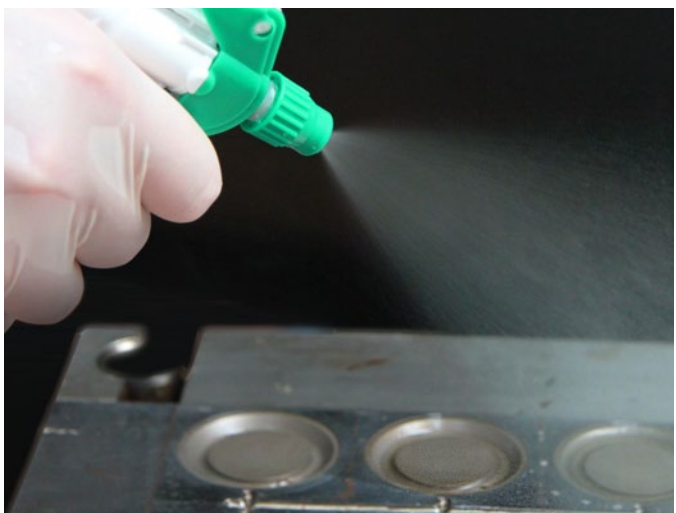
Manuelle Reinigung von Kunststoffspritzguss-Werkzeug
