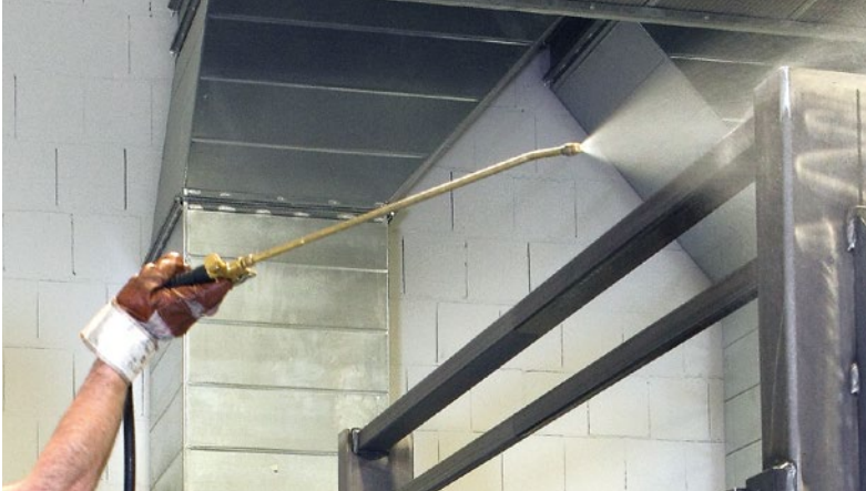
Reinigen vorm Lackieren mit den FTs
