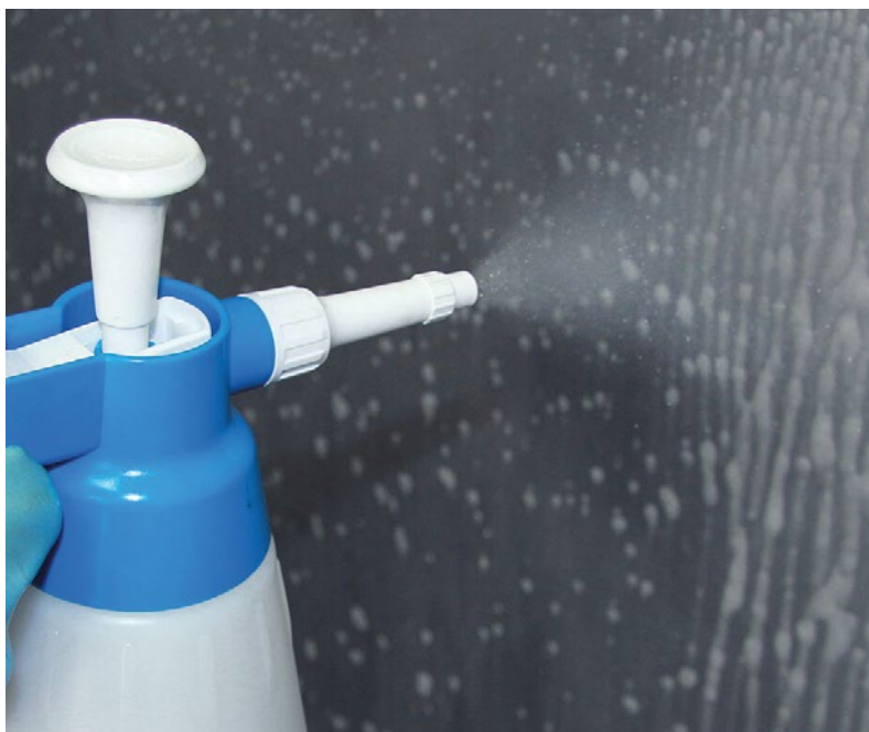
Reiniger großflächig auftragen mit Druckpumpzerstäuber 1,5 l.
