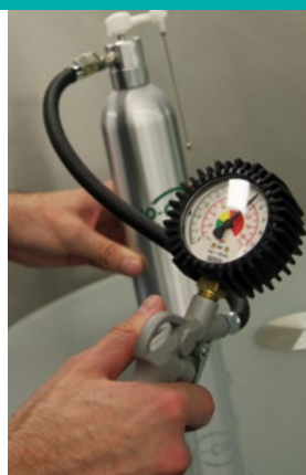
Flasche aufschrauben – Reiniger einfüllen – zuschrauben – mit Druckluft auffüllen
