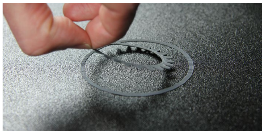
Leichtes Ablösen der Druckteile
