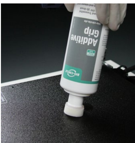
3D-Haft- und Trennmittel auf Druckbett auftragen.
