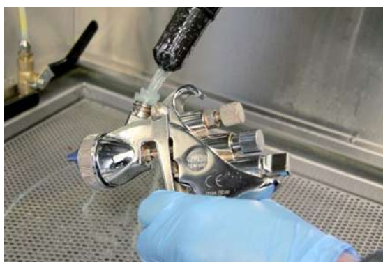
Reinigen von Lackierpistolen und -Zubehör im PROLAQ Auto
