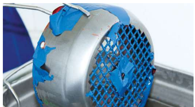
Mit PROLAQ L US Lackentfernung im Ultraschallbad
