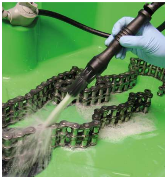
Reinigung överschmutzter Teile im BIO-CIRCLE GT-i
