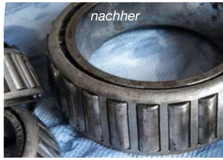
Reinigung mit STAR US 6 im Ultraschallreinigungsgerät
