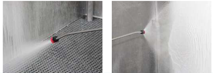
Reiniger auftragen mit Druckluft-Schaumlanze
