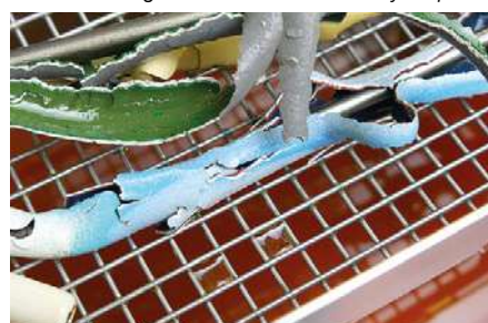
Lackentfernung im Ultraschallbad mit Poly Strip 100
