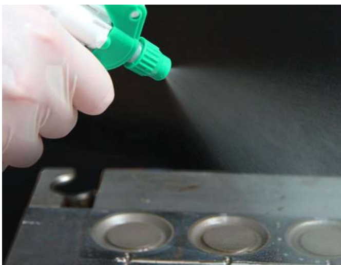
Manuelle Reinigung von Kunststoffspritzguss-Werkzeug
