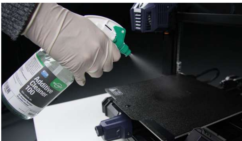
Nach dem Druck Reinigen der Druckeroberfläche mit 3D-Reiniger. Aufsprühen und abwischen.
