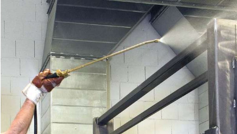
Reinigen vorm Lackieren mit den FTs
