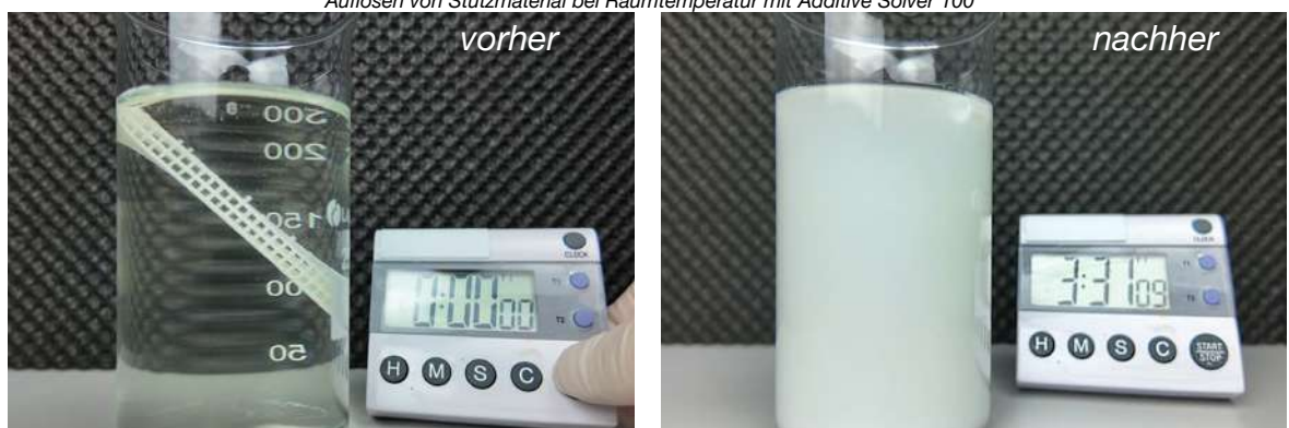
Auflösen von Stützmaterial bei Raumtemperatur mit Additive Solver 100
