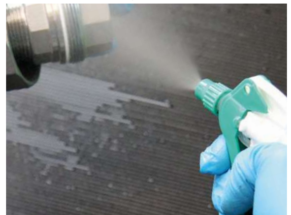
GS 200 aufsprühen – Dichtungsmasse entfernen
