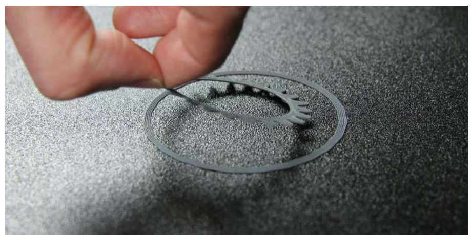
Leichtes Ablösen der Druckteile
