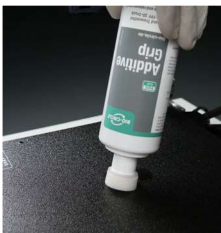
3D-Haft- und Trennmittel auf Druckbett auftragen.
