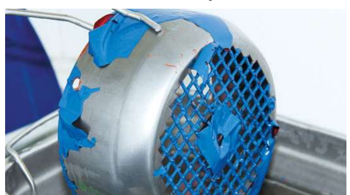
Mit PROLAQ L US Lackentfernung im Ultraschallbad
